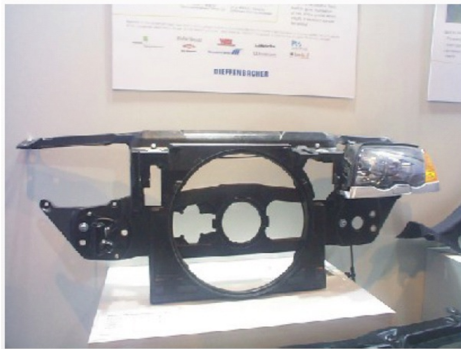
Pièce de façade automobile fabriquée en PP renforcé par des fibres de verre
