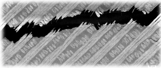
Observation par microtomographie de la rupture dans un composite \pm 45 chanvre/époxy.
