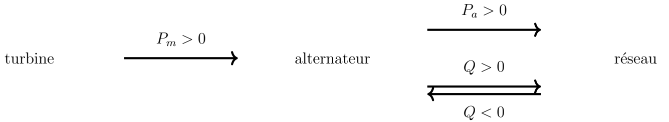
FIGURE 3 – Transferts de puissance (cas alternateur)
