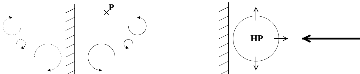
FIG. 6.1 – Vue schématique des effets non-visqueux dus à la présence de la paroi. A gauche : effet d'écho de paroi. A droite : effet de blocage.
