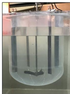
Figure 2 : Photographie de cuve agitée chicanée, où les plaques en métal proches des parois de la cuve sont les chicanes qui augmentent localement la turbulence du fluide agité.
