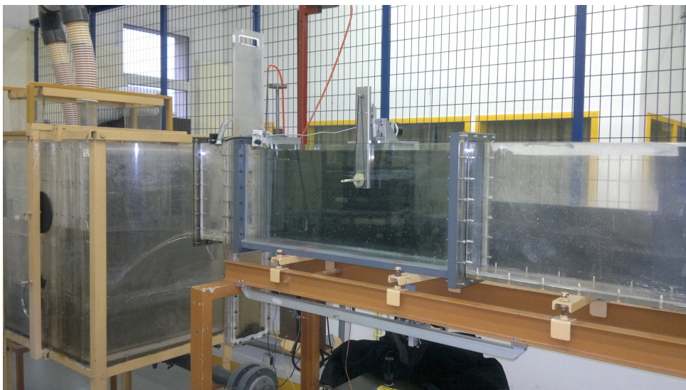
FIGURE 3.4 – Canal hydraulique de l'ENSEM permettant d'étudier les écoulements autour d'obstacle. Ce canal est équipé d'une nappe laser et de colorant pour visualiser les lignes de courant.
