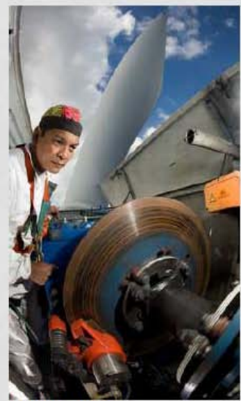
Vérification du frein à disque de l'arbre rapide
