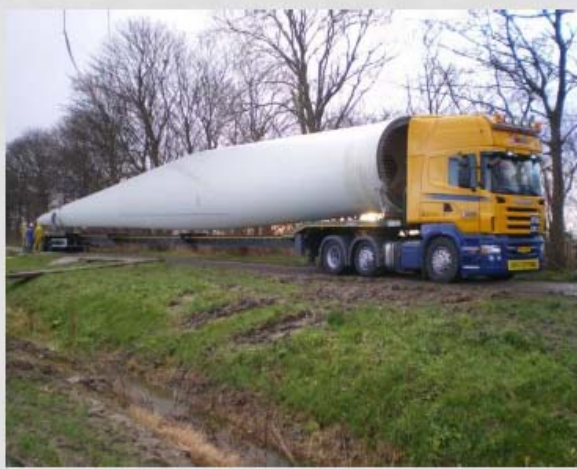
Transport d'une pale par convoi exceptionnel
