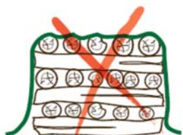
Ventilation mauvaise du bois, voire nulle
