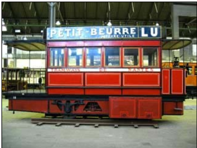
Tramway à air comprimé utilisé à Nantes entre 1878 et 1917
