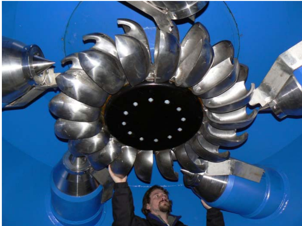
Turbine Pelton alimenté par 5 jets
