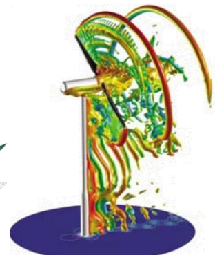
Etude de l'écoulement d'air autour d'une éolienne
