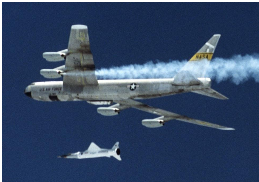
Largage d'un avion à statoréaction
