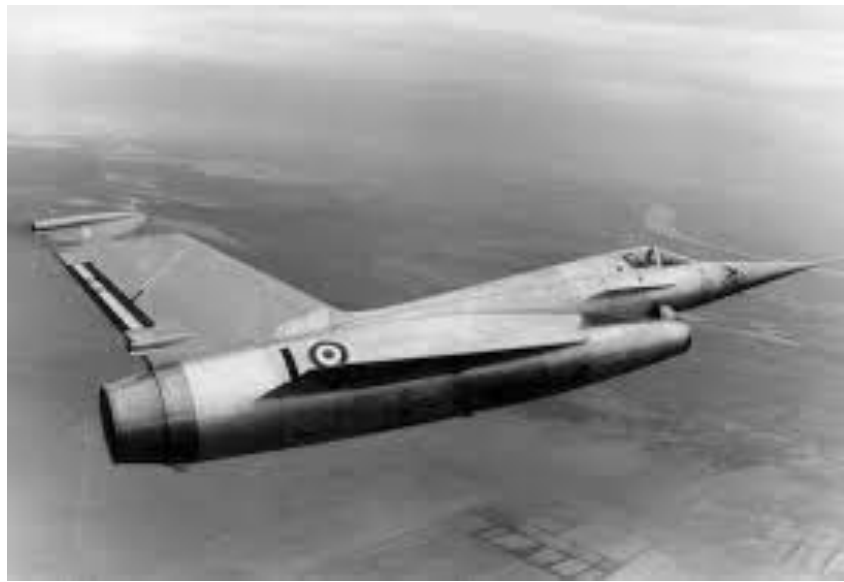
Statoréacteur Leduc monté sur un avion Griffon (Nord 1500)
