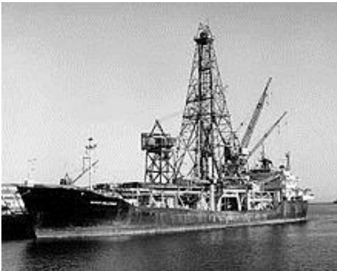
(Glomar Challenger, USA, 1960-1980: 2000 puits dans le plancher océanique sous des profondeurs d'eau allant jusqu'à 9000m)
