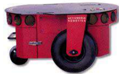
Pioneer P3-DX 2004 (Active Média) 2 moteurs DC avec codeurs odométrie, 8 capteurs US Option bumper, télémètre laser, gyroscope 44 cm, 38cm, 22 cm 9 kg
