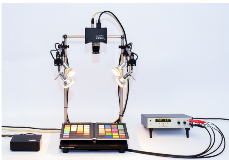
Figure 1: Montage et connexions de la caméra snapscan
