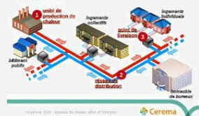
Schéma de principe d'un réseau de chaleur
