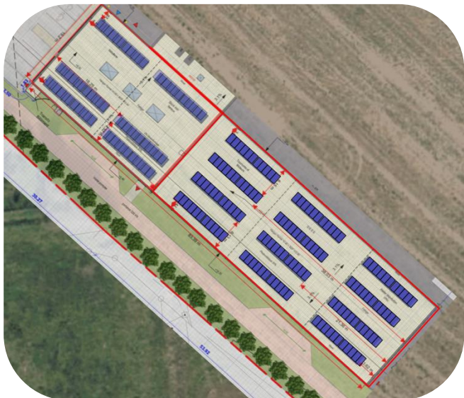
Toit bac acier 5° 77kWc
