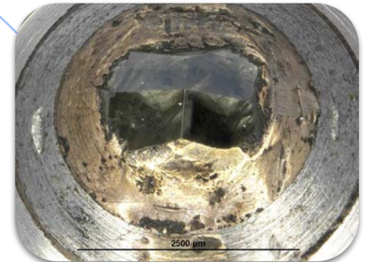
Pyramide diamant à base carré angle sommet 136^\circ
