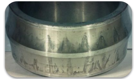
Corrosion par humidité - 20%
