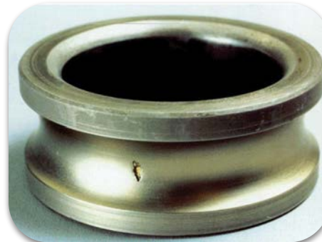
Fatigue en sous-couche - 6%
