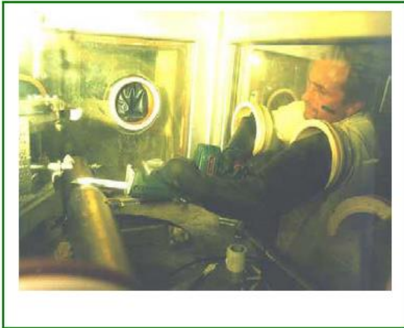
Découpe à la scie alternative dans une boîte à gants
