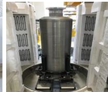
Conteneur In Can à l'intérieur du four de vitrification et découpe du Can
