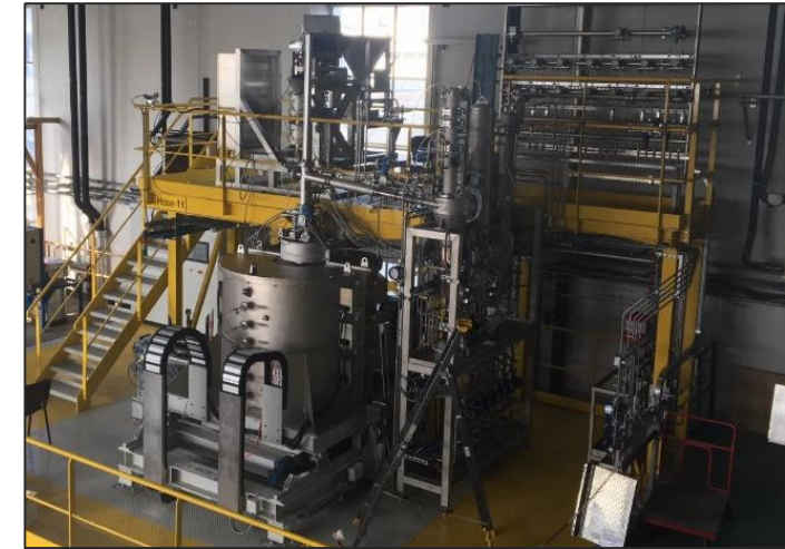
Vue d'ensemble du procédé de vitrification Dem&Melt
