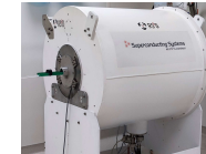
Vélocimétrie par résonance magnétique nucléaire (IRM) dans un écoulement
